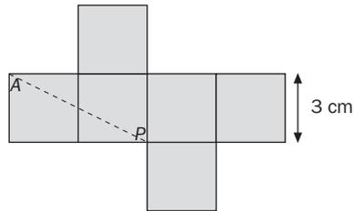
La distancia mínima es la línea recta que une los dos puntos, que coincide con la diagonal del rectángulo de altura 3 cm y base 6 cm.
